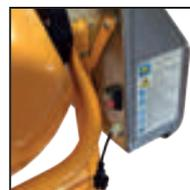
Clavija e interruptor start/stop en una posición muy cómoda.
