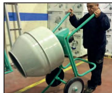
La RIOBETA-140 es la pequeña hormigonera transportable con grandes prestaciones. Las dimensiones muy reducidas, hacen de la RIOBETA-140 una máquina fácil de transportar a cualquier sitio, para ser utilizada tanto en la obra como en el interior de la vivienda.
