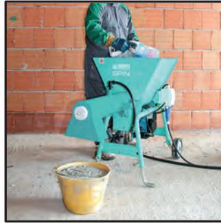
Mezcla morteros ensacados con gran rapidez (15/18 l/min.)
