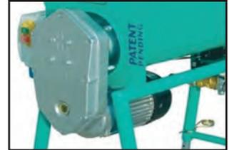
Transmite la potencia del motor a las palas de mezcla mediante un reductor con engranajes de acero tratado en baño de aceite. Con este sistema directo de transmisión, se garantiza unas prestaciones más elevadas, eliminándose las típicas averías que se producen por el sistema de transmisión de la potencia mediante correas.
