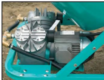
Compresor eléctrico de membranas (original IMER)
