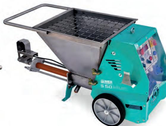
Su panel de control, sencillo e intuitivo, está equipado con el Exclusivo Inverter IMER, capaz de monitorizar continuamente la presión y de compensar automáticamente el desgaste de la camisa y las diferencias de fluidez entre unos materiales y otros, garantizando siempre una pulverización totalmente homogénea.
