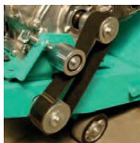
La transmisión es mediante sólo una única y ancha correa de tipo Poly - V. Esta característica es muy importante, porque al ser una única correa, su correcta tensión esta garantizada, a diferencia de otras máquinas que montan varias correas de transmisión, siendo muy difícil realizar una tensión totalmente uniforme, ya que por el uso, unas pueden estar más desgastadas y estiradas que otras.
