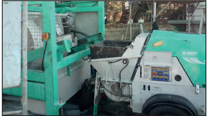
Alimentación mediante central de hormigonado a radio rascante
