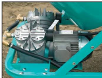
Compresor eléctrico de membranas (original IMER)
