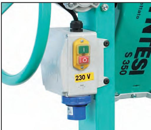
Todos los modelos con motor eléctrico están equipados con interruptores con protección IP 55 con bobina. La protección térmica protege el motor de las sobrecargas; la bobina impide la puesta en marcha involuntaria de la máquina después de una pérdida de tensión.
