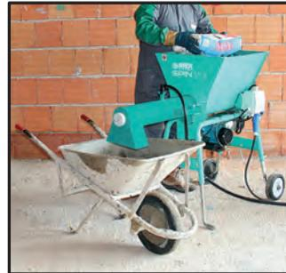
Mezcla morteros ensacados con gran rapidez (15/18 l/min.)
