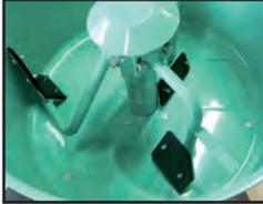
Kit's de raspadores de goma para colocar en sus palas de mezcla, muy útiles tanto para la limpieza perimetral de la cuba como de su fondo. Se recomienda sobre todo cuando los materiales son especialmente adherentes con resinas.
