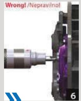
6 Wrong! / Nepravilno! Cuando la herramienta está en posición comprimida y la golpeamos con un martillo, el mecanismo interno se destruye. Nunca golpee la herramienta con un martillo cuando esté comprimida.
