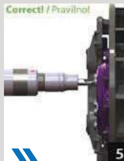
5 Correct! / Pravilno! Acerque la herramienta al tornillo y no la presione hasta la posición final antes de utilizarla. Con el golpe de martillo, la herramienta se extrae automáticamente y comienza el apriete/aflojamiento.
