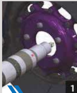
1 Acercar el destornillador de impacto al tornillo, que apretaremos (R), o aflojaremos (L).
