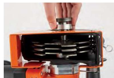
Cambio de herramienta sin esfuerzo mediante husillo de seguridad dividido y anillos distanciadores precisos
