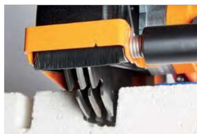
La escasa distancia entre la cubierta protectora y el disco de corte de diamante permite trabajar cerca de los bordes, hasta 18 mm.
