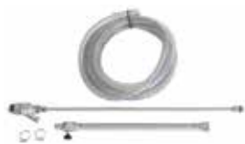
Sand/Soda blasting lance kit completa di testina, sonda regolabile e tubo gomma aspirazione. Con attacchi rapidi M24x1,5 (600 bar)
